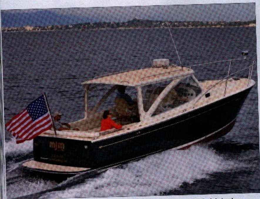
Une coque rétro à l'arrière frégatée, mais un mode de fabrication moderne qui fait appel à l'infusion.
